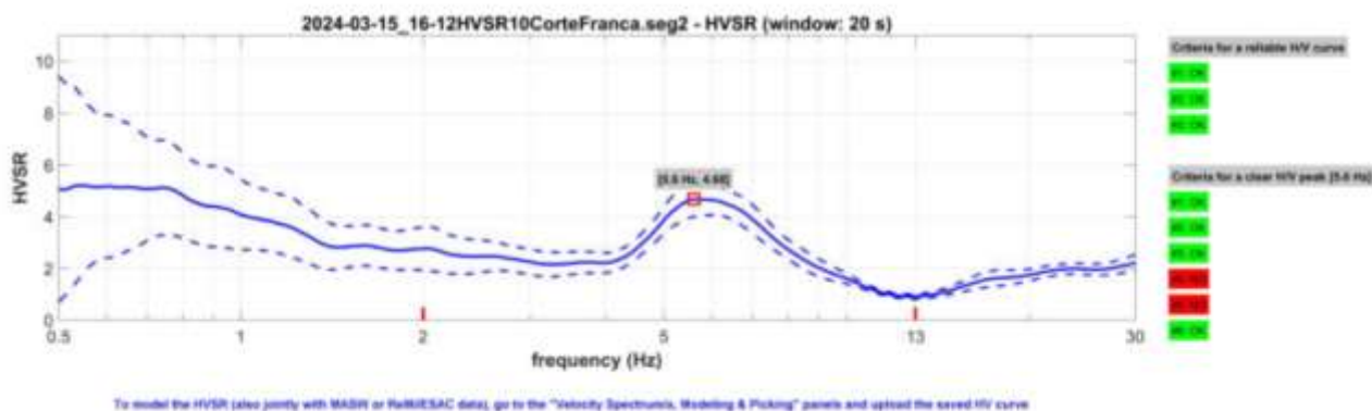
Figura 24: Curva HVSAR10 misurata in campagna e controllo criteri SESAME picco a 4,68 Hz
