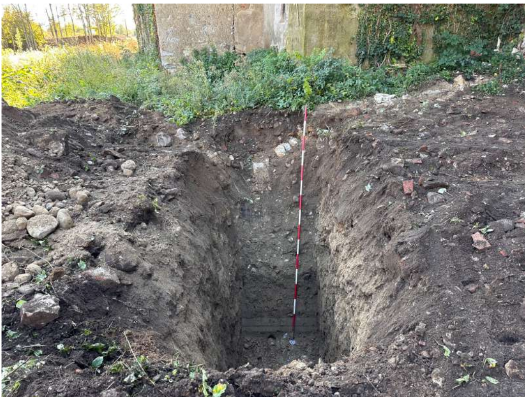
SONDAGGIO 12: LO STERILE È STATO RAGGIUNTO A CIRCA M 1,70 DAL P.D.C AL DI SOPRA È PRESENTE UN RIPORTO DI TERRENO UTILIZZATO PER LA CREAZIONE DEL TERRAZZAMENTO SU CUI SORGE IL COMPLESSO
